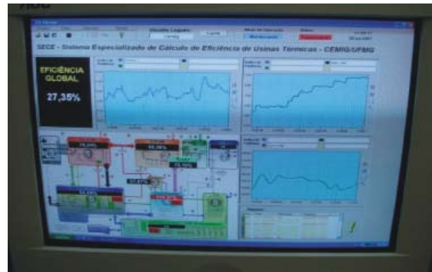
Figura 2: Destaque da tela da estação de monitoramento ilustrando os gráficos de tendência da eficiência e variáveis do processo.
