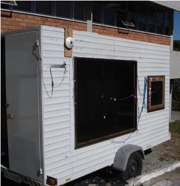
Figura 3. Vista externa do calorímetro durante um teste
