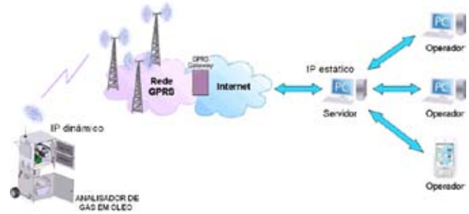
Figura 2 – Topologia do sistema de comunicação GPRS
