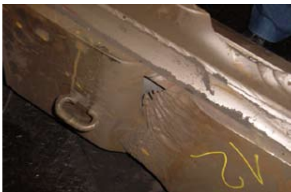
Figura 2. Dorso de proteção da lança de óleo severamente desgastado por erosão.
