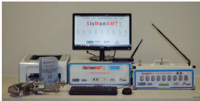
Figura 1. SisMonAMT Sistema de Monitoramento do Aterramento Móvel Temporário.
