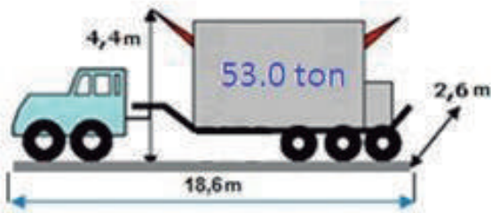
Figura 1. Limites de peso e de dimensões físicas que devem ser atendidos de maneira a evitar a necessidade de licenças especiais de tráfego
