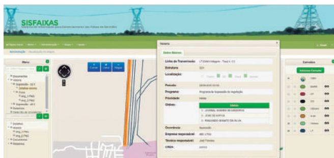
Figura 3. SISFAIXAS - Janela informativa sobre uma vistoria realizada em linha de transmissão.
