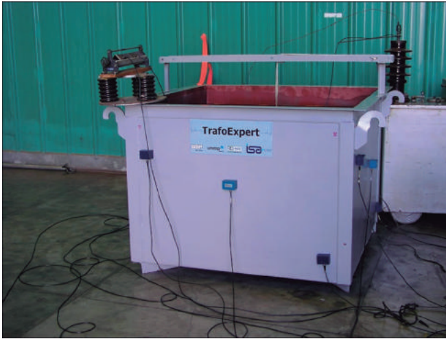
Figura 2. Tanque Experimental para ensaios de descargas parciais.
