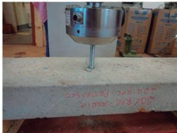
Figura 1. Ensaio aplicado à placa de ancoragem.
