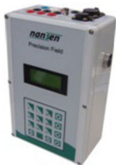
Figura 1. Aspecto Externo do Padrão de Energia.
