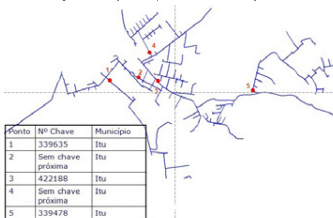
Figura 7 – Pontos definidos para instalação do sinalizador de faltas.
