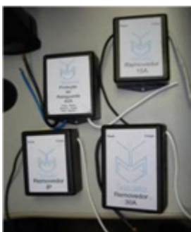
Figura 3: Removedor de Ruído e proteção de retaguarda
