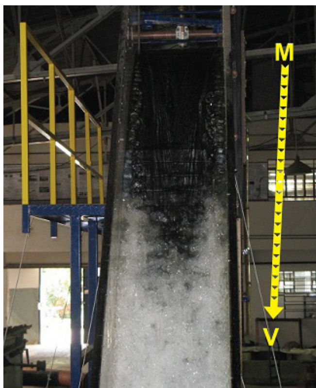
Figura 4. Escoamento sobre os degraus: vista frontal do modelo.
