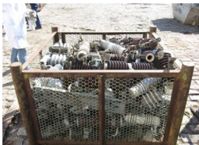
Figura 2 – Caixa com "Chaves-Faca, Chaves Fusível e Para-Raios"
