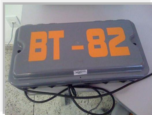
**Figura 4** – Dispositivo de Religa e Corte com adesivo de identificação que diferencia as caixas de derivação COELCE
