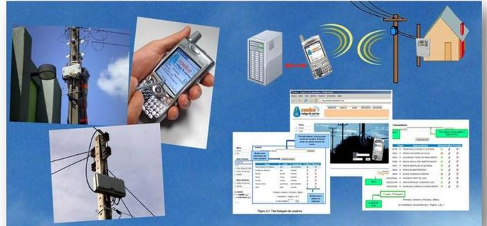
Figura 1 – Arquitetura funcional do sistema de Religa & corte
